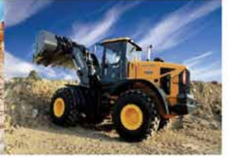
ÇUKUROVA 980 LASTİK TEKERLEKLİ YÜKLEYİCİ 3,5 m 3 - 20.000 KG.
