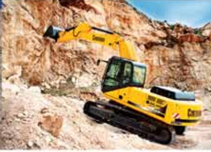
ÇUKUROVA CMI723 PALETLİ EKSKAVATÖR 23.000 KG.
