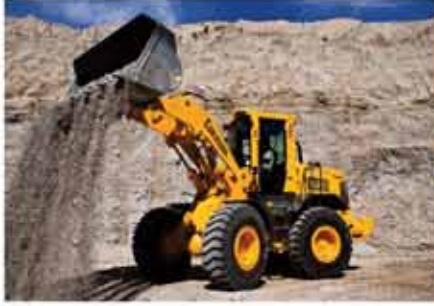
ÇUKUROVA 940 LASTİK TEKERLEKLİ YÜKLEYİCİ 2,5 m 3 - 14.000 KG.
